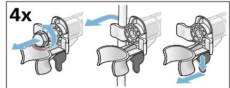
3. Mettez les couvercles en place. Verrouillez fermement les couvercles en appuyant sur le crochet de crantage.
