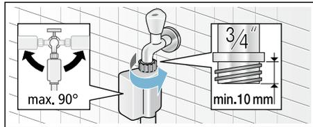
**Remarque :** Ouvrez prudemment le robinet d'eau et vérifiez en même temps si les raccords sont étanches. La jonction par vis se trouve sous la pression régnant dans la conduite d'eau.
