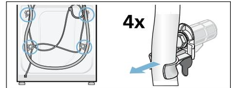
2. Dévissez les 4 cales de transport au complet et retirez-les. Enlevez les douilles. Sortez le cordon électrique de ses fixations.
