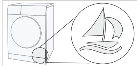
Automatické čištění sušičky způsobuje klepání.
