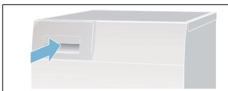
**Upozornění:** Sítko v nádržce na kondenzovanou vodu filtryuje kondenzovanou vodu, která se používá pro automatické čistění sušičky. Sítko se čistí vyprázdněním kondenzované vody. Přesto sítko pravidelně kontrolujte, zda v něm nejsou usazené nečistoty a odstraňte je. Viz → Strana 29.
