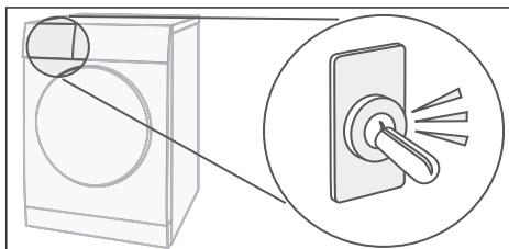
Čerpadlo odčerpává kondenzovanou vodu do nádržky na kondenzovanou vodu, Přitom vydává zvuky čerpání.
