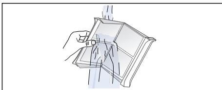
7. Filtry na vlákna osušte, zaklopte je a dvoudílný filtr na vlákna nasaděte zpět.
