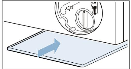
7. Entleerungsschlauch aus der Halterung nehmen.
