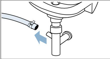
4. Ablaufschlauch und Siphon-Stutzen reinigen.
