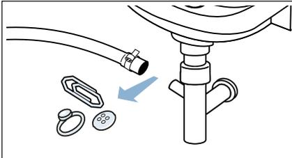
5. Ablaufschlauch wieder aufstecken und Anschluss-Stelle mit Schlauchschelle sichern.
