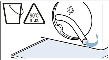
10. Entleerungsschlauch in die Halterung einsetzen.
