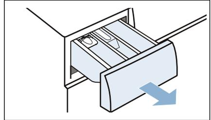
2. Einsatz herunterdrücken und Waschmittelschublade vollständig herausnehmen.
