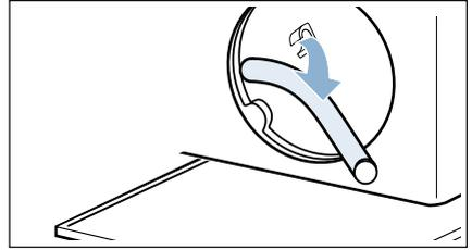
8. Verschlusskappe abziehen und Lauge in geeignetes Gefäß abfließen lassen.
