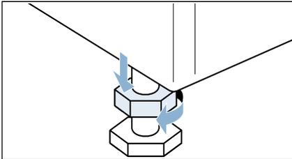
2. Gerät durch Drehen der Gerätefüße ausrichten. Ausrichtung mit Wasserwaage überprüfen.
