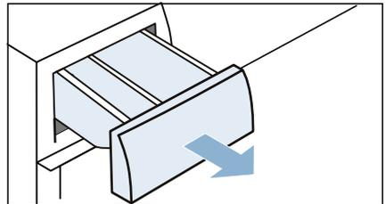
2. Einsatz herunterdrücken und Waschmittelschublade herausziehen.
