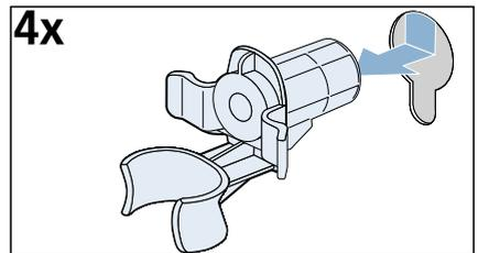
5. Abdeckkappen einsetzen und durch Druck auf den Rasthaken fest verriegeln.
