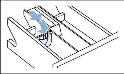
5. Waschmittelschublade einsetzen und schließen.
