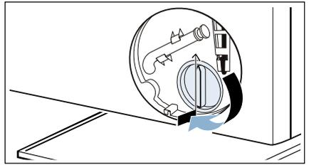
14. Serviceklappe einsetzen und einrasten.
