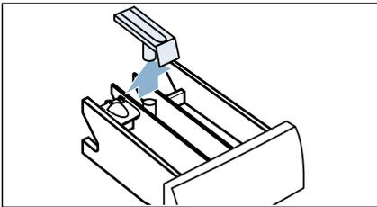
6. Gehäuse der Waschmittelschublade im Gerät reinigen.
