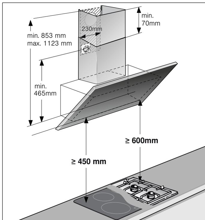
**Указание:** Мы рекомендуем устанавливать прибор таким образом, чтобы нижний край стеклянного экрана находился на одной линии с нижним краем соседнего навесного шкафа. Убедитесь в соблюдении указанных безопасных расстояний до варочной панели.
