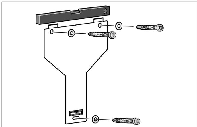
Затяните винты крепления вытяжки от руки, выровняйте вытяжку с помощью ватерпаса, после чего окончательно плотно затяните винты.
