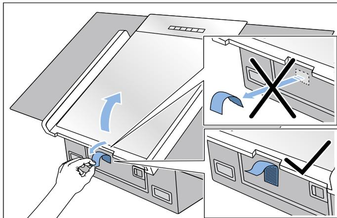
2. Выньте пенопласт и металлический жирулавливающий фильтр из прибора.
