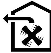
Втянутый воздух очищается жироулавливающим фильтром и подаётся по системе труб наружу.
