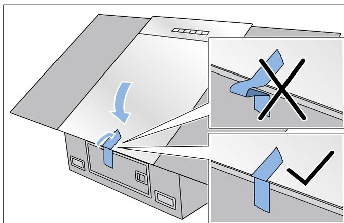
**Указание:** Закрепите клейкую ленту таким образом, чтобы крышка из нержавеющей стали не вибрировала.
