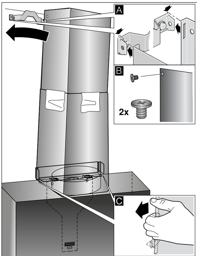
7. Зафиксируйте нижнюю секцию вытяжной трубы в крепёжном уголке. Не допускайте повреждения сетевого провода! **C**
