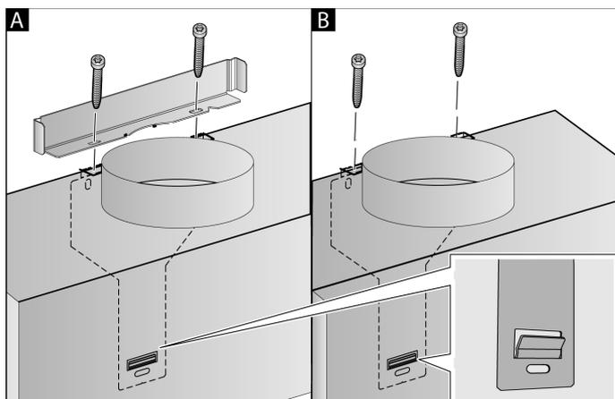
4. Если не монтируется канал, затяните два установочных винта без углового профиля. **B**
