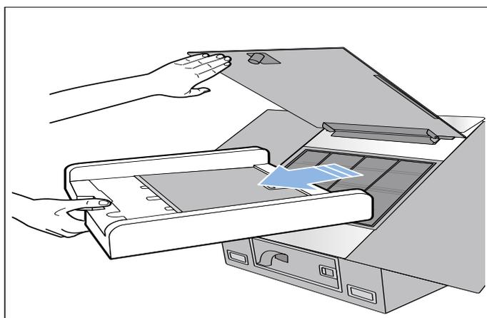
3. Установите металлический жирулавливающий фильтр в прибор. См. указания по установке в главе → "Установка металлического жирулавливающего фильтра" на страница 8.
