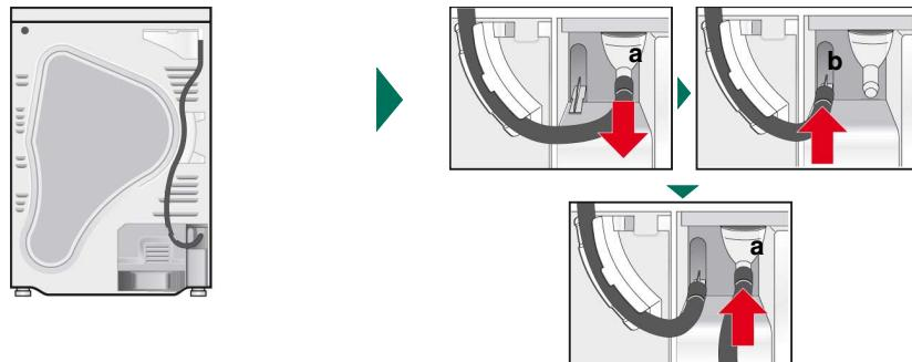
Leveringstilstanden til tørketrommelen: For å lede kondensvannet til kondensvannsbeholderen er slangen festet på stussen.
