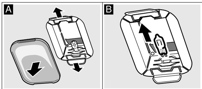
4. Remettre en place le cache en verre. Ce faisant, l'insérer d'un côté et l'appuyer fermement de l'autre côté. Le verre s'encliquete.
