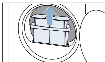
3. Odstraňte vlákna z prohlubně filtru na vlákna. Dbejte na to, aby žádná vlákna nespadla do otevřeného otvoru.
