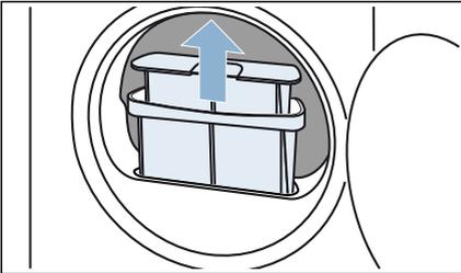
3. Die Flusen aus der Mulde des Flusensiebes entfernen. Darauf achten, dass keine Flusen in den offenen Schacht fallen.
