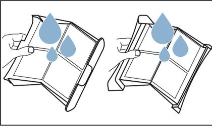
8. Flusensiebe abtrocknen, zuklappen und wieder einsetzen.
