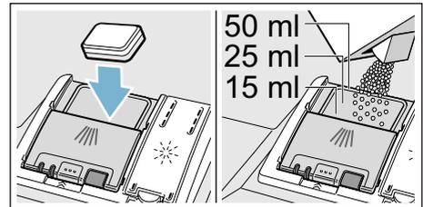
4. Deckel der Reinigerkammer schließen.
