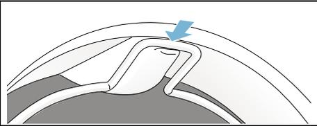
Le panier à laine doit à présent être fermement inséré dans le tambour.
