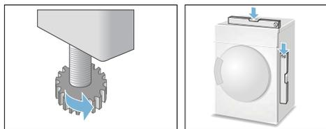
Un alignement incorrect peut engendrer de hauts niveaux de bruits, des vibrations et un mouvement incorrect du tambour.
