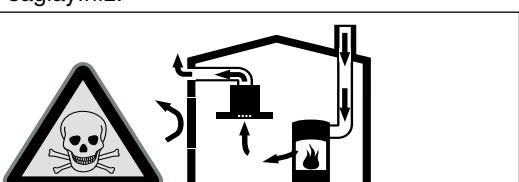
Hava dolaşımı ateşlikler (örneğin gaz, yağı, odun veya kömürle çalışan sobalar, şöfbenler, su ısıtıcıları) yanma havasını kurulum yerinden alırlar ve atık gazı bir atık gaz sistemi (örneğin baca) kanalıyla dışarıya aktarırlar.
