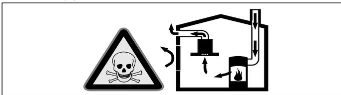
Ohniská závislé od vetrania miestnosti (napr. vyhrievacie prístroje na plyn, olej, drevo alebo uhlie, prietokové ohrievače, ohrievače vody) odoberajú dymové plyny z miestnosti, kde sú nainštalované a odvádzajú ich odsávacím zariadením (napr. komin) von.
