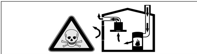
Uzavřené spotřebiče paliv (např. tepelné spotřebiče na plyn, olej, dřevo nebo uhlí, průtokové ohřivače, bojler) odebírají spalovací vzduch z místnosti, ve které jsou nainstalované, a spaliny odvádějí zařízením pro odvod spalin (např. komínem) ven.
