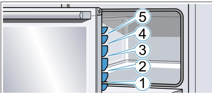
Das Zubehör in die Haken rechts und links einsetzen. Beim Einsetzen des Zubehörs darauf achten, dass es fest in den Haken eingerastet ist, es kann sonst herunterfallen.
