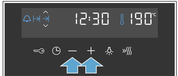
Nach wenigen Sekunden übernimmt das Gerät die Einstellungen. Im Display steht die Endezeit. Sobald das Gerät startet, läuft die Dauer ab.
