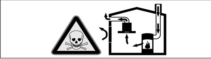
Hava dolaşımli ateşlikler (örneğin gaz, yağ, odun veya kömürle çalışan sobalar, şöfenler, su ısıtıcıları) yanma havasını kurulum yerinden alırlar ve atık gazı bir atık gaz sistemi (örneğin baca) kanalıyla dışarıya aktarırlar.
