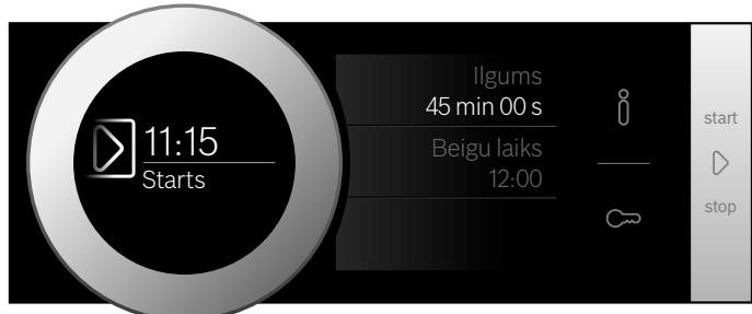
Ierīce ir gaidīšanas režīmā. Kad ierīces ieslēdzas, displejā redzama gatavošanas laika atskaite.
