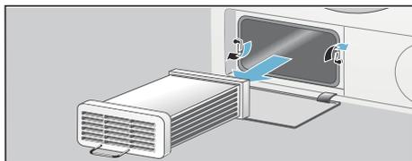
6. Nettoyez l'échangeur thermique de chaque côté au jet d'eau afin de retirer entièrement toutes les peluches.
