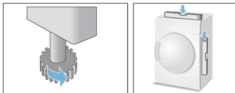
Un mauvais alignement peut entraîner des vibrations et des mouvements incorrects du tambour.
