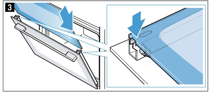
5. Abdeckung aufsetzen und andrücken bis sie hörbar einrastet (Bild 4).
