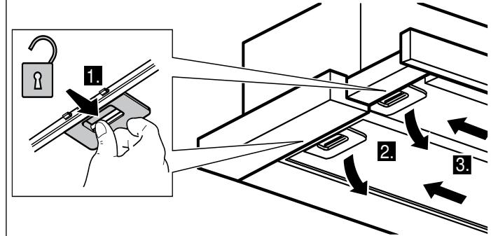
**Υπόδειξη:** Λίπος μπορεί να έχει συσσωρευτεί στο κάτω μέρος στο μεταλλικό φίλτρο λίπους. Κρατάτε οριζόντιο το μεταλλικό φίλτρο λίπους, για να αποφύγετε το στάξιμο του λίπους.
