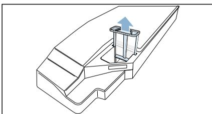
11. Вставьте фильтр в углубление резервуара для конденсата.
