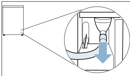
**Указание:** На момент поставки прибора шланг для конденсата закреплен на штуцере.
