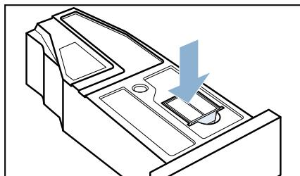
12. Задвиньте резервуар для конденсата до фиксации.
