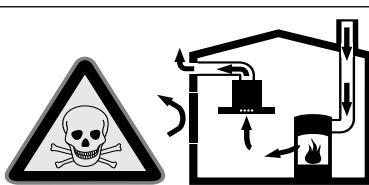
Huoneilmaa tarvitsevat tulisijat (esim. kaasu-, öljy-, puu- tai hiilikäytöiset lämmityslaitteet, läpivirtauskuumennin, vedenkuumennin) ottavat poltoilman huonetilasta ja johtavat poistoilman poistoilmalaiteen (esim. savutorven) kautta ulos.
