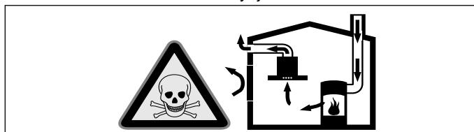
Eldstäder som är beroende av rumsluft (t.ex. värmearrapparater som drivs med gas, olja, ved eller kol, genomströmningsapparater, varmvattensberedare) tar sin förbränningluft ur det utrymme där enheten är installerad och leder ut avgaserna i det fria via en avgasanläggning (t.ex. skorsten).
