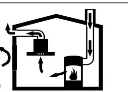
Ildsteder, hvis lufttilførsel sker fra indeluften, (f.eks. gas-, olie-, træ- eller kulfyrede varmeapparater, gennemstrømningsvandvarmere, vandvarmere) henter deres forbrændingsluft fra opstillingsrummet og fører røggassen ud gennem en røggaskanal(f.eks. skorsten) til det fri.
