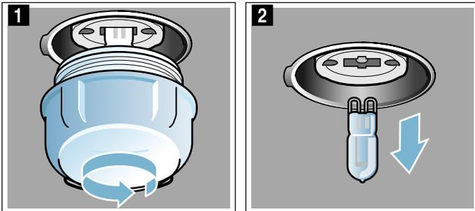
4. Glasabdeckung wieder einschrauben. Je nach Gerätetyp ist die Glasabdeckung mit einem Dichtring ausgestattet. Dichtring vor dem Einschrauben wieder aufsetzen.
