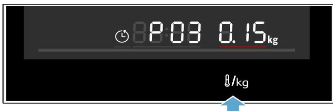
4. Réglez le poids de 1 kg à l'aide du sélecteur rotatif. L'appareil règle automatiquement la durée adaptée au poids.
