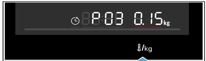
4. Met de draaiknop een gewicht van 1 kilo instellen. Het apparaat stelt automatisch de tijdsduur in die bij het gewicht past.
