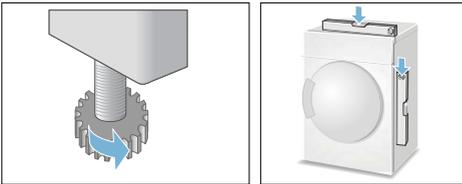
Una nivelación incorrecta puede provocar un elevado nivel de ruido, vibraciones y un movimiento inadecuado del tambor.
