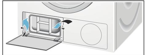
4. Retirar la cubierta superior del intercambiador térmico.
