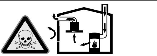
Hava dolaşımı ateşlikler (örneğin gaz, yağı, odun veya kömürle çalışan sobalar, şöfbenler, su ısıtıcıları) yanma havasını kurulum yerinden alırlar ve atık gazı bir atık gaz sistemi (örneğin baca) kanalıyla dışarıya aktarırlar.
