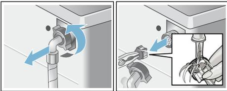
3. Schlauch anschließen und auf Dichtheit prüfen.
