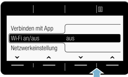
5. Sie können die Home Connect Einstellungen verlassen, indem Sie die Taste **Fernstart**
