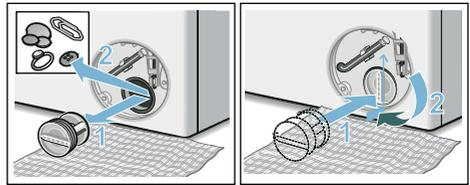
6. Service-Klappe einsetzen, einrasten und schließen.
