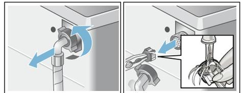
3. Schlauch anschließen und auf Dichtheit prüfen.
