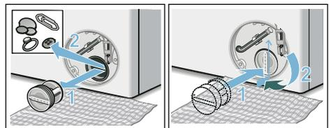
6. Service-Klappe einsetzen, einrasten und schließen.
