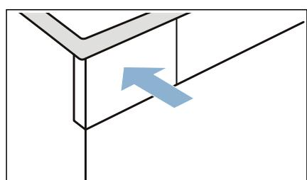
**Anvisning:** Silen i kondensattanken filtrerar kondensatet till autorengöringen av maskinen. Rengör silen genom att tömma ur kondensatet. Kontrollera om det finns avlagringar i silen med jämma mellanrum och ta bort dem, om det behövs.
