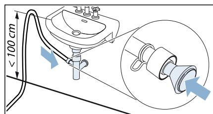
Fäst anslutningen med slangklämma (spänvidd 12-22 mm, finns att köpa i fackhandeln).
