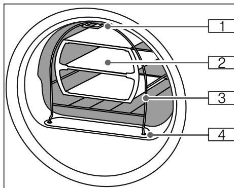
1 Fot för fäste på haken i överdelen av maskinens frontvägg
