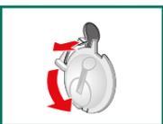
2. Alle 4 Transportsicherungen einsetzen und das Netzkabel in die Halterungen klemmen. Schrauben festziehen.
