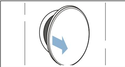
2. Feuchtigkeitssensor mit angerauhtem Schwamm reinigen.
