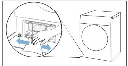
3. Hebel der Wärmetauscher-Abdeckung entriegeln.
