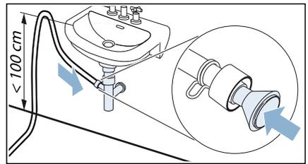
Anschluss-Stelle muss mit Schlauchschelle gesichert werden (Spannereich 12-22 mm, Fachhandel).
