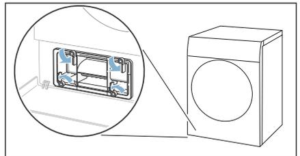
4. Wärmetauscher-Abdeckung am Griff herausziehen.
