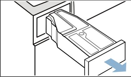
8. Kondenswasser-Behälter um 180° auf die Unterseite drehen und den eingesetzten Stöpsel entfernen.
