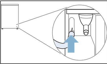
5. Ablaufschlauch aus dem Zubehör nehmen und am freiliegenden Stutzen befestigen und bis zum Anschlag schieben.
