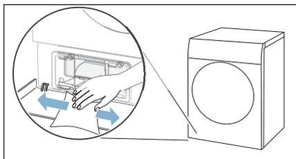
3. Déverrouillez le levier du couvercle de l'échangeur thermique.
