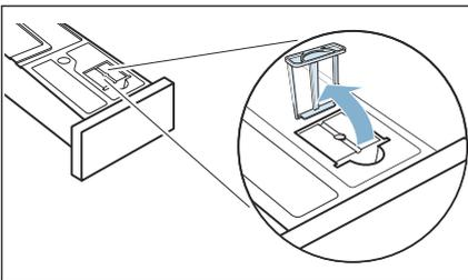
2. Retirez le bouchon de la cavité du réservoir d'eau de condensation.
