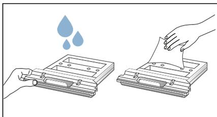
8. Nettoyez l'ouverture de l'appareil avec un chiffon doux et humide.
