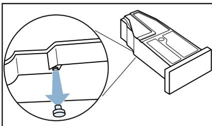
9. Tournez le réservoir d'eau de condensation de nouveau à 180° et introduisez le bouchon dans la cavité située sur le dessus du réservoir d'eau de condensation.
