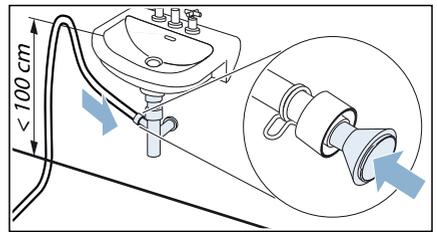
Le point de raccordement doit être fixé par un collier de serrage (plage de serrage 12-22 mm, commerce spécialisé).
