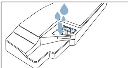
**Remarque :** Maintenez toujours le réservoir d'eau de condensation rempli à l'horizontale pour qu'aucun liquide ne s'écoule.
