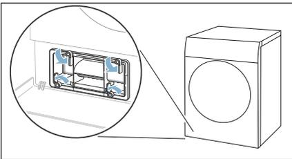
4. Wärmetauscher-Abdeckung am Griff herausziehen.
