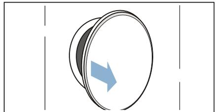
2. Feuchtigkeitssensor mit angerauhtem Schwamm reinigen.
