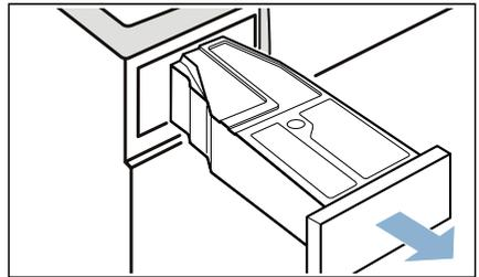
9. Den Kondenswasser-Behälter bis zum Einrasten einschieben.
