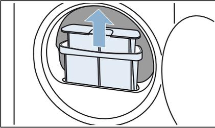
3. Die Flusen aus der Mulde des Flusensiebes entfernen. Darauf achten, dass keine Flusen in den offenen Schacht fallen.
