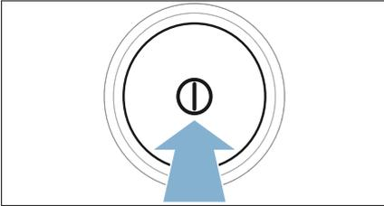
10. Netzstecker des Geräts vom Stromnetz trennen.
