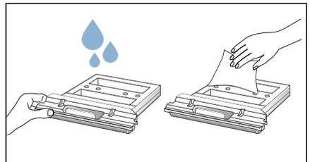
8. Öffnung des Geräts mit einem weichen, feuchten Tuch reinigen.
