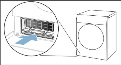
10. Wärmetauscher-Abdeckung am Griff einschieben.
