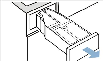
7. Eine Flasche des Original-Pflegemittels und ca. 1 ½ Liter heißes Leitungswasser in den Kondenswasser-Behälter füllen.
