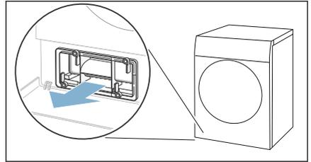
5. Wärmetauscher-Abdeckung mit weicher Bürste reinigen.
