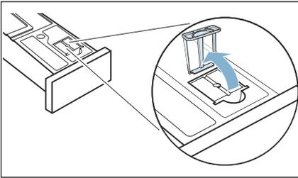
2. Den eingesetzten Stöpsel aus der Vertiefung des Kondenswasser-Behälters entfernen.
