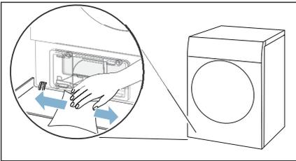
3. Hebel der Wärmetauscher-Abdeckung entriegeln.
