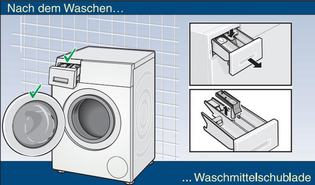
... Waschmittelschublade und Einfüllfenster offen lassen, damit Restwasser abtrocknen kann. Ggf. die Schublade herausziehen und reinigen.
