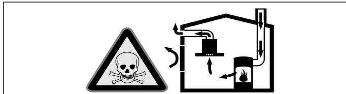
依賴室內空氣的製熱裝置（例如以煤氣、汽油、木材或以煤炭為燃料的暖爐、連續式暖爐或熱水器）係從其安裝處取得空氣加以燃燒，再經由排氣系統（例如煙囪）將廢氣排放至室外。
