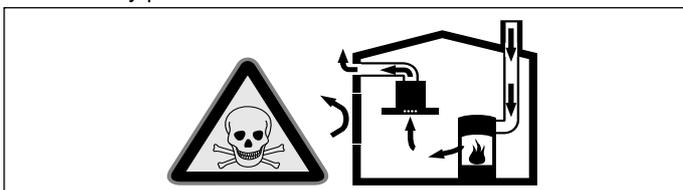
Ohniská závislé od vetrania miestnosti (napr. vyhrievacie prístroje na plyn, olej, drevo alebo uhlie, prietokové ohrievače, ohrievače vody) odoberajú dymové plyny z miestnosti, kde sú nainštalované a odvádzajú ich odsávacím zariadením (napr. komin) von.
