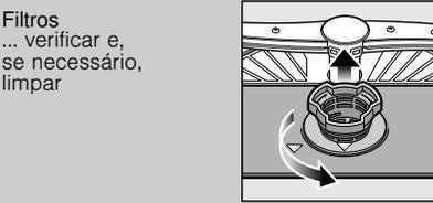
Rodar o filtro cilíndrico e retirar o sistema de filtros ...
