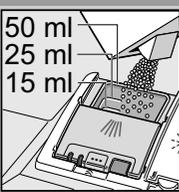
Rengjøringsmiddel på i det tørre kammeret for rengjøringsmiddel.
