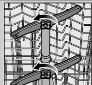
skruva loss de övre spolarmarna ...
