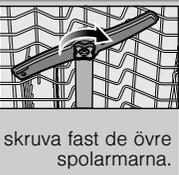
skruva fast de övre spolarmarna.
