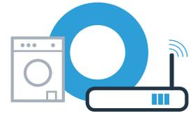
Bei der manuellen Verbindung baut Ihr Hausgerät ein eigenes WLAN Netzwerk (Access Point) auf, in das Sie sich mit Ihrem Smartphone oder Tablet PC einwählen.
