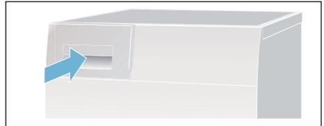
**Remarque :** Le filtre du réservoir à condensat filtre la condensation qui est utilisée pendant le cycle de nettoyage automatique du sèche-linge. Le filtre est nettoyé en vidant la condensation. Cependant, vous devez vérifier le filtre régulièrement pour retirer les éventuels dépôts qui y subsistent. Voir → Page 35.
