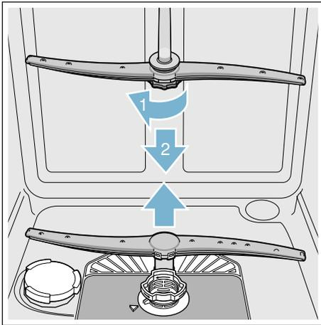
4. Sprüharme unter fließendem Wasser reinigen.
