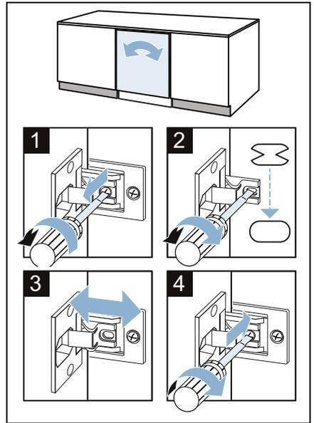
**13.** Colocar el tope de deslizamiento del panel de zócalo.
