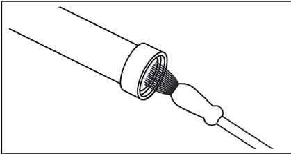
3. En los modelos estándar y Aqua-Secure, limpiar el filtro de la parte posterior del aparato: Retirar la manguera de la parte posterior del aparato.
