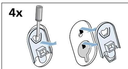
2. Colocar los 4 casquillos. El cable de conexión puede fijarse a la sujeción.
