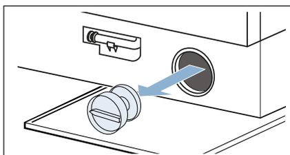
9. Limpiar el compartimento interior, la rosca de la tapa de la bomba y la carcasa de la bomba. La rueda de aletas de la bomba de vaciado debe girar.
