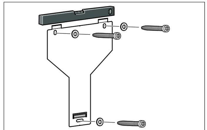
Die Aufhängung für die Dunstabzugshaube handfest anschrauben, mit einer Wasserwaage ausrichten und festschrauben.
