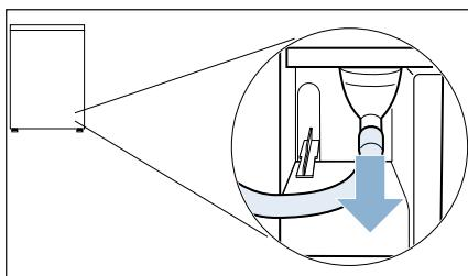
**Указание:** В състоянието на доставка на уреда маркучът за кондензатна вода е закрепен върху накрайника.
