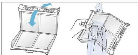
6. Séchez le filtre à peluches, fermez-le, puis remettez en place le filtre à peluches.
