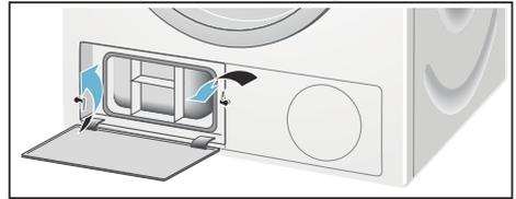
4. Retirez la patte de fixation de l'échangeur thermique.
