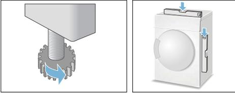
Un mauvais alignement peut entraîner des vibrations et des mouvements incorrects du tambour.
