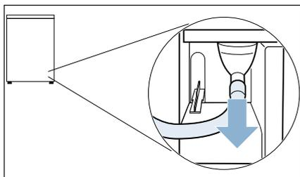
**Conselho:** Quando o aparelho é fornecido, a mangueira de água de condensação está fixada no bocal.
