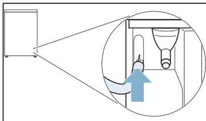
5. Retire a mangueira de escoamento do acessório, fixe-a ao bocal colocado a descoberto e insira-a até ao batente.
