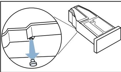
9. Volte a rodar o recipiente de água de condensação 180° e insira o tampão no rebaixo, na parte superior do recipiente de água de condensação.
