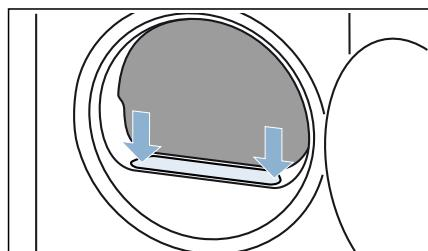
**Anvisning:** Silen i kondensattanken filtrerar kondensatet till autorengöringen av maskinen. Rengör silen genom att tömma ur kondensatet. Kontrollera om det finns avlägringar i silen med jämna mellanrum och ta bort dem, om det behövs.
