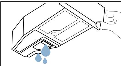
3. Skjut in kondensattanken så att den snäpper fast igen i maskinen.
