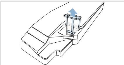
**11.** Sätt filtret i fördjupningen på kondensattanken.
