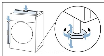
3. Rikta upp maskinen med maskinfötterna, om det behövs. Nu kan du ansluta maskinen.
