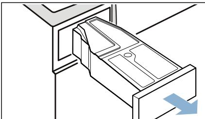
5. Häll destillerat vatten i påfyllningsöppningen med den medföljande kannan tills
