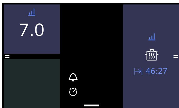
V hlavnej oblasti máte prehľad o jednotlivých varných zónach vo forme, ako sú usporiadané aj na vašom varnom paneli. Vidíte zvolené druhy ohrevu, výkonové stupne a časové funkcie vašich aktívnych stupňov varenia. Dotykom varnej zóny prejdete rovno do oblasti nastavenia príslušnej varnej zóny.
