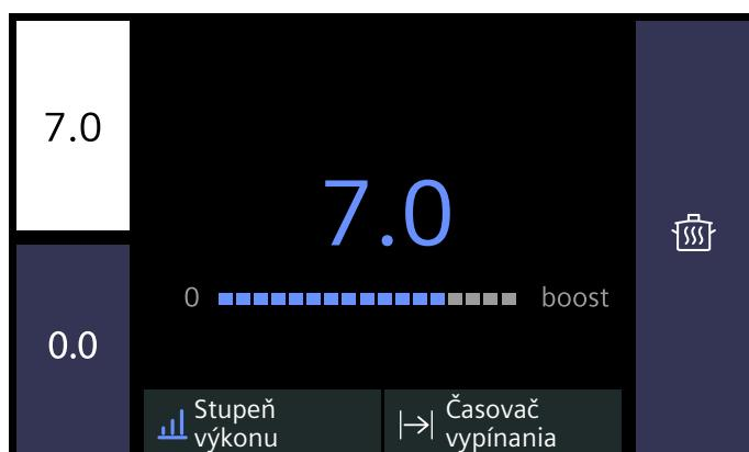
V oblasti nastavenia varnej zóny sa môžu nastaviť rôzne režimy varenia a výkonové stupne pre príslušnú varnú zónu. Výkonové stupne zmeníte priamym dotykom alebo posúvaním prsta po stupnici. Režimy varenia zmeníte tak, že sa dotknete poľa s aktívnym režimom varenia.
