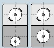
Přední a zadní varné zóny vždy se dvěma induktory lze používat nezávisle na sobě. Nastavte pro každou samostatnou varnou zónu požadovaný stupeň výkonu. Na každé varné zóně používejte pouze jednu nádobu.
