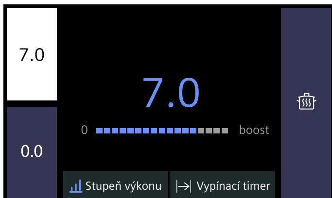
V oblasti nastavování varné zóny můžete nastavit různé režimy vaření a stupně výkonu pro příslušnou varnou zónu. Stupně výkonu můžete změnit přímým dotknutím, nebo přejetím po stupnici. Režim vaření změňte dotknutím políčka s aktuálním režimem vaření.
