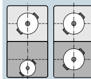
Predné a zadné varné zóny s dvomi induktormi sa môžu používať navzájom nezávisle. Nastavte pre každú varnú zónu zvlášť požadovaný výkonový stupeň. Použite na každej varnej zóne len jednu nádobu.
