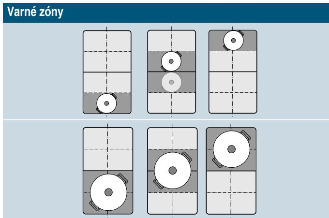
Pomocí této funkce lze umístěním nádoby v jiné oblasti během vaření přizpůsobit stupně výkonu.
