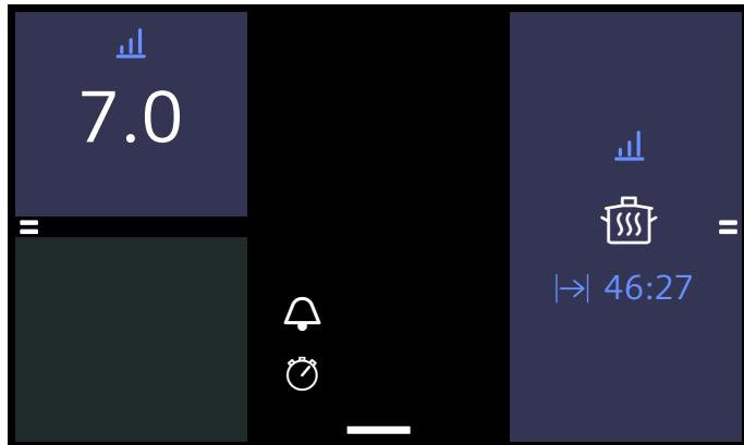
V hlavní oblasti máte přehled o jednotlivých varných zónách tak, jak jsou umístěny na varné desce. Vidíte zvolené druhy ohrevu, stupně výkonu a časové funkce aktivních stupňů vaření. Dotknutím varné zóny přejdete do oblasti nastavování příslušné varné zóny.
