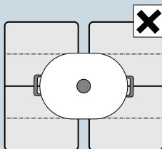
Ak ide o varné panely s viac ako jednou flexibilnou varnou zónou postavte nádobu tak, aby bola zakrytá len jedna flexibilná varná zóna.
