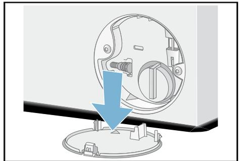
5. Entleerungsschlauch aus der Halterung nehmen. Verschlusskappe abziehen, Lauge in geeignetes Gefäß abfließen lassen. Verschlusskappe aufdrücken und Entleerungsschlauch in die Halterung einsetzen.
