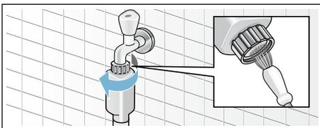
6. Sieb einsetzen, Schlauch anschließen und auf Lecks prüfen.
