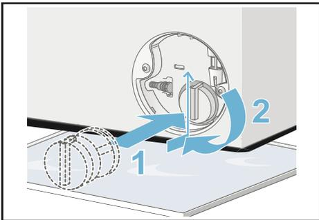
8. Service-Klappe einsetzen und einrasten.
