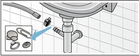
4. Ablaufschlauch wieder aufstecken und Anschluss mit Schlauchschelle sichern.
