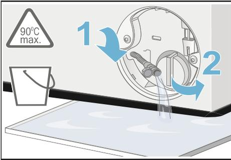
6. Pumpendeckel vorsichtig abschrauben, Restwasser kann auslaufen. Innenraum, Gewinde des Pumpendeckels und Pumpengehäuse reinigen. Das Flügelrad der Laugenpumpe muss sich drehen lassen.
