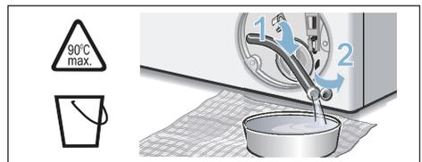
5. Pumpendeckel vorsichtig abschrauben, Restwasser kann auslaufen. Innenraum, Gewinde des Pumpendeckels und Pumpengehäuse reinigen. Das Flügelrad der Laugenpumpe muss sich drehen lassen.
