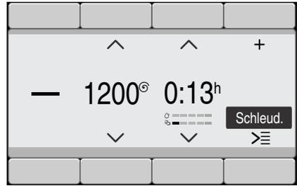
Zum Ändern die Taste unter dem schwarz hinterlegten Programm wählen und Programm ändern.
