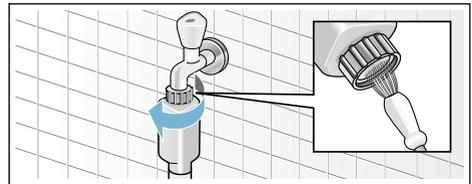
2. Bei Modellen Standard und Aqua-Secure Sieb an der Geräterückseite reinigen: Schlauch an der Geräterückseite abnehmen, Sieb mit Zange herausnehmen und reinigen.
