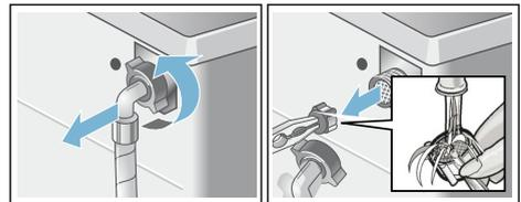
3. Schlauch anschließen und auf Dichtheit prüfen.
