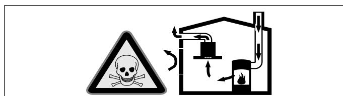
Εστίες, εξαρτημένες από τον αέρα του περιβάλλοντος (π.χ. συσκευές θέρμανσης που λειτουργούν με αέριο, πετρέλαιο, ξύλο ή άνθρακα, ταχυθερμοσίφωνες, θερμαντήρες νερού) λαμβάνουν τον αέρα για καύση από το χώρο τοποθέτησης και οδηγούν τα καυσαέρια μέσα από μια εγκατάσταση απαγωγής των καυσαερίων (π.χ. καμινάδα) στον έξω χώρο.
