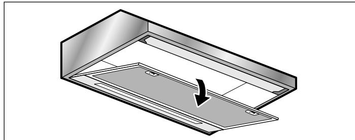
3. Τοποθετήστε λοξά το φίλτρο πλέγματος και αφαιρέστε το.
